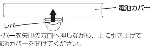
図2 電池を抜き取る。
