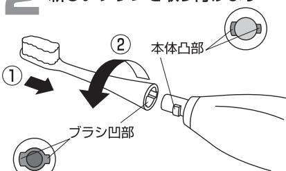
※ブラシの凹部と本体の凸部を図のように合わせてさし込みます。
