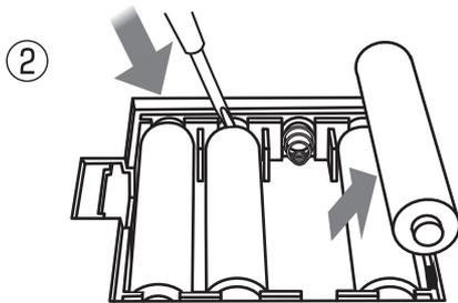
② 古い電池を抜き取ります。このときマイナスドライバー等の先が尖ったものを使い、左図のように矢印の方向から取り出してください。
