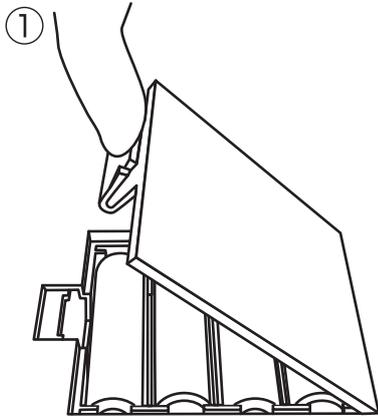
① 裏側の電池カバーのツメを押し上げて開け、取りはずします。
