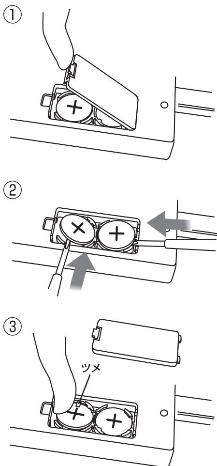
① 裏側の電池カバーのツメを押し上げて開け、取りはずします。
