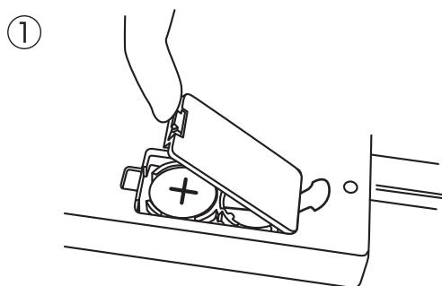
① 裏側の電池カバーのツメを押し上げて開け、取りはずします。
