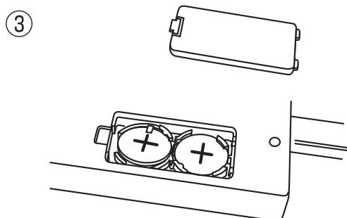
③ 電池カバーの2つの突起を電池ボックスの穴に合わせ、パチッと音がするまで押し込んで閉じます。
