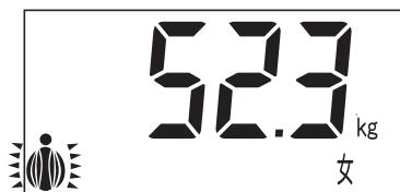
判定結果は、体脂肪率・体水分量・筋肉量・基礎代謝量・推定骨量の順で表示され、それを2回繰り返した後、自動的に電源が切れる。
