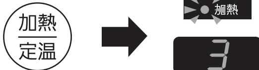
●「加熱 / 定温」ボタンで「加熱モード」「定温モード」の切り替えができます。
