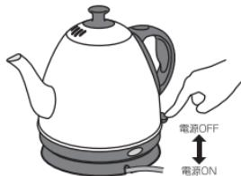
お湯が沸騰すると電源ランプが消灯し、ON/OFFスイッチが自動的に切れます。
