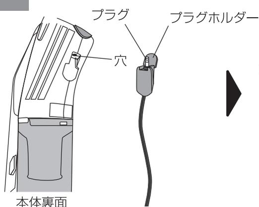
プラグホルダーを本体裏のクボミ部分に沿って下方向からスライドさせる。プラグをしっかりと穴に差し込む。
