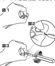
2.人差し指で電池カバーの合わせ、目部分を下に押さえつけた状態を保ち、側面の電池カバーと本体の隙間にマイナスドライバーを差し込む(図2)。
