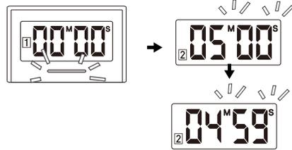
6.「5分」のカウントダウンが終了すると、アラーム(ビビッ、ビビッ)とLEDランプの点滅(約2秒間)でお知らせ後、再度「25分」のカウントダウンがスタートする。
