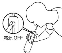
**8** 電源が切れていることを確認して水タンクに残った水を捨て、本体内部の水抜きをする。
