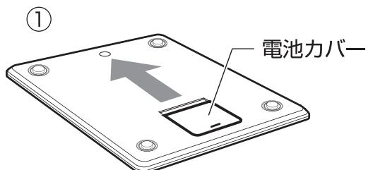
① 本体裏側の電池カバーを矢印方向へスライドさせて取りはずします。
