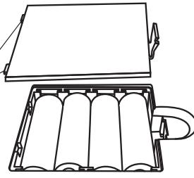
③ 電池カバーの2つの突起を電池ボックスの穴に合わせ、パチッと音がするまで押し込んで閉じます。
