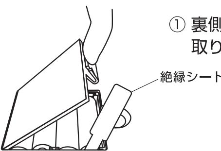
① 裏側の電池カバーのツメを押し上げて開け取りはずします。
