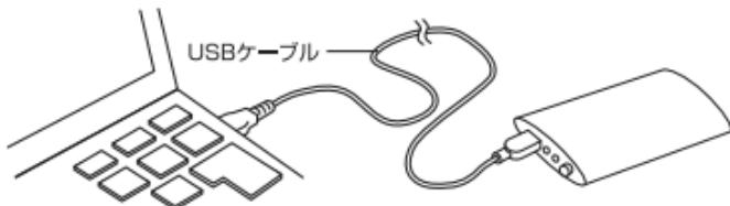
2.本製品のミニUSBジャックにUSBケーブルのミニUSBプラグを接続します。もう一方のUSBプラグをパソコンなどのUSBポートに接続します。
