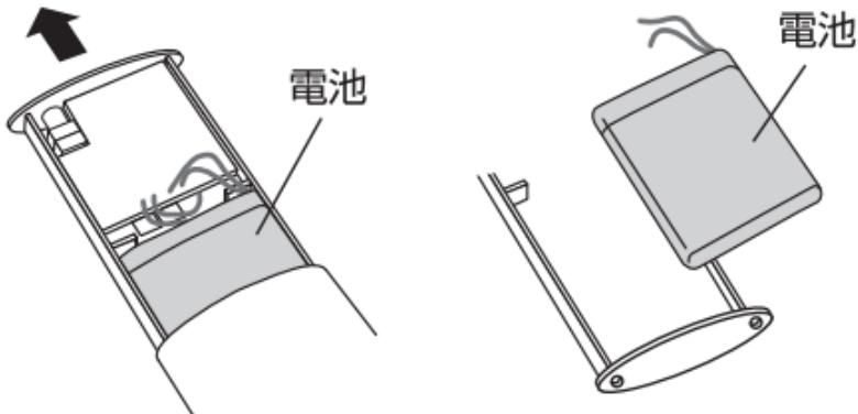
取り出したリチウムイオン電池はショート防止のため、リード線の切断部に絶縁テープを貼っておおった後、充電式電池リサイクル協力店に設置してある「充電式電池リサイクルBOX」にいれてください。
