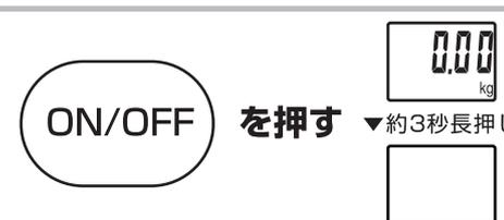
荷物を下ろしたあと、ON/OFFボタンを押すと「0.00kg」に戻ります。さらに約3秒長押しすると、ピーツと音が鳴り電源が切れます。
