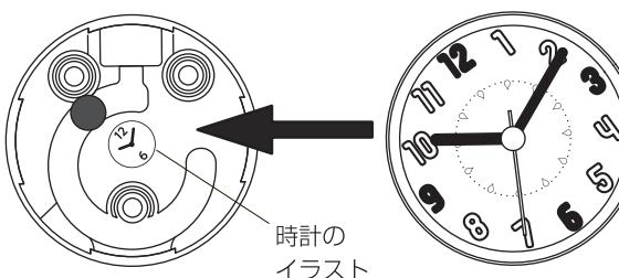
5) レンズを押さえ、カバーを「CLOSE」の方向へ止まるまで回し、取り付ける。
