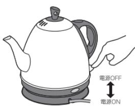
お湯が沸騰すると電源ランプが消灯し、ON/OFFスイッチが自動的に切れます。
