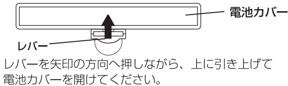
図2 電池を抜き取る。
