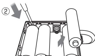
② 古い電池を抜き取ります。このときマイナスドライバー等の先が尖ったものを使い左図のように矢印の方向から取り出してください。
