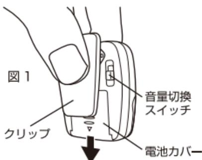
電池カバーを開けるときはクリップを押さえながらカバーを矢印の方向に引いて、開けてください。
